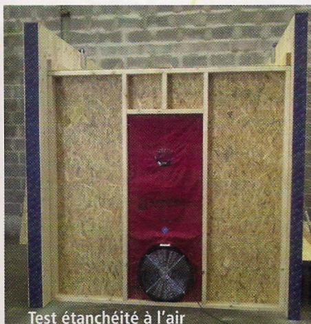
Test étanchéité à l'air
